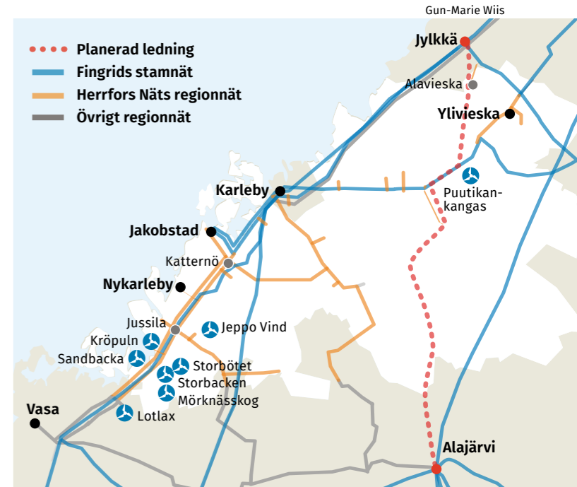
Herrforsgruppens nätområde med de ledningar som hör till stamnätet och regionnätet och med de åtta vindkraftsparker, som har anslutningsavtal med Herrfors Nät, markerade.
